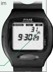
Ihre Uhrzeitanzeige sieht so aus, wenn Sie zuletzt im **Herzfrequenz-Modus** trainiert haben. In diesem Fall beginnt der folgende Startvorgang mit der **Herzfrequenz-Messung**. Durch gleichzeitiges Drücken der SET/START/STOP- und der SIGNAL/LIGHT-Taste wechseln Sie in den Fahrrad-Modus, woraufhin dieser gestartet wird.
