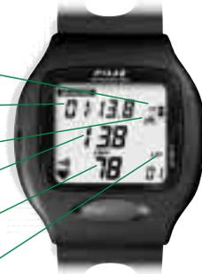
\* **Fahrrad-Infoschleife:** Tageskilometerstrecke, Stoppuhr, Uhrzeit, Durchschnittsgeschwindigkeit, Kilometer, gesamte Fahrzeit, Höchstgeschwindigkeit, Höhenunterschied in Metern/Fuß (separat lieferbarer Polar Höhenmesser erforderlich).
